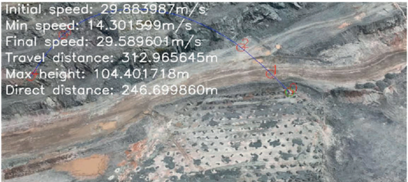
Figura 5: Trayectoria y parámetros relativos a la proyección de un fragmento de roca
