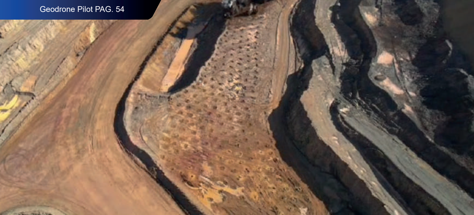
Figura 3: Levantamiento aéreo del proceso de detonación
